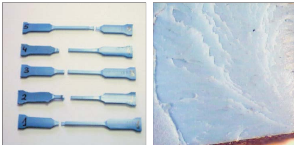
Instantánea de las probetas tras la rotura. Microfotografía
